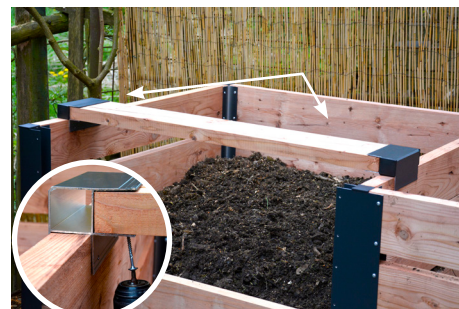
8. Volitelné příslušenství: Zpevňující fošnu vložíme do 15cm profilů a nasadíme na horní část kompostéru. Až poté fošnu přivrutujeme.
